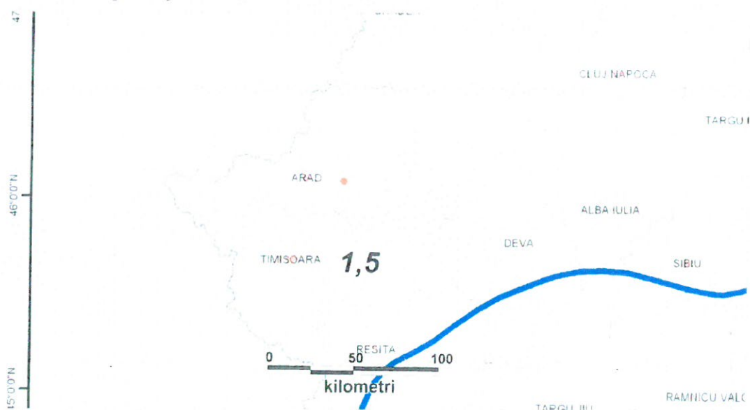
Figura 4 – Evaluarea acțiunii zăpezii asupra construcțiilor
